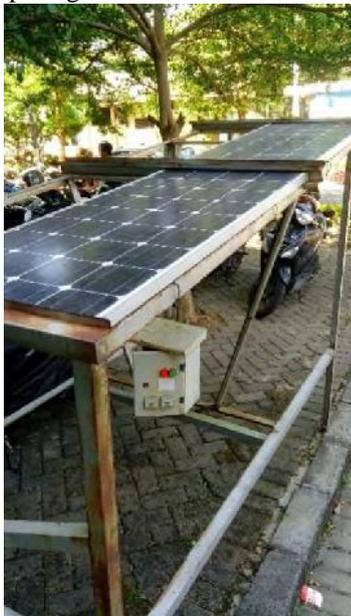
Gambar 3. Miniatur Sistem Off- Grid Lab. Energi Terbarukan
