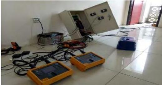
Gambar 11. Pengujian Auto-Switch Mini PLTS
