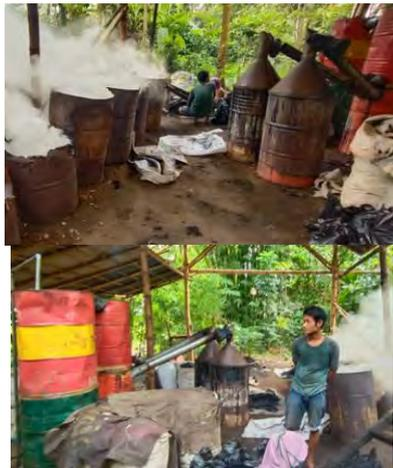
Gambar 3. Pembuatan Instalasi Asap dan Uji Operasi
