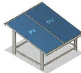
Gambar 6. Desain rangka penyangga panel PV
