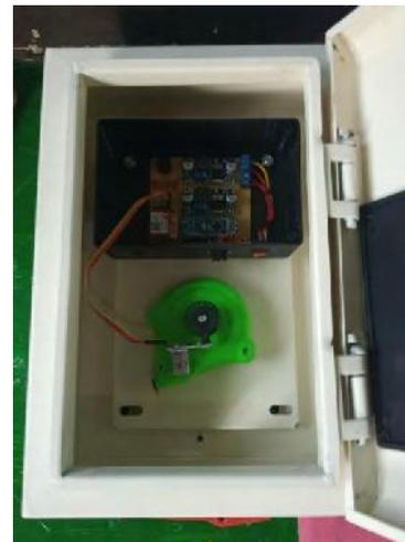
Gambar 2. Rangkaian deteksi longsor
