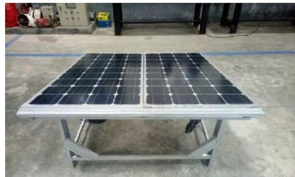
Gambar 7. Hasil implementasi rangka penyangga panel PV
