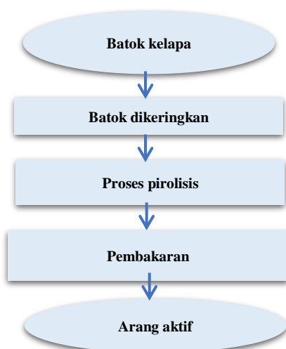
Gambar 4. Diagram alir pembuatan arang aktif
