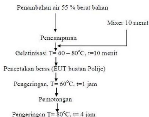
Gambar 1. Diagram Proses Pembuatan Beras Tiruan (Betis) Polije.
