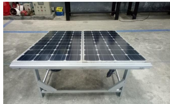
Gambar 7. Hasil implementasi rangka penyangga panel PV
