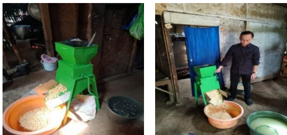
Gambar 6. Proses Finalisasi Alat Pemisah Biji Kedelai dengan Kulitnya
