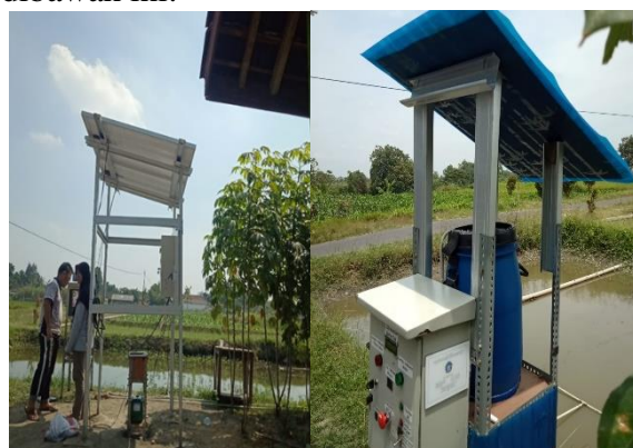
Gambar 1 Alat pemberi makan ikan (feeder) dengan sumber tenaga matahari (solar cell)
