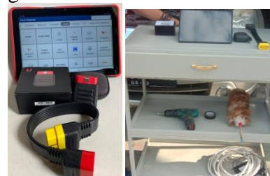
Gambar 5 ADR OBD II, Tablet dan Software, Kabel Data
