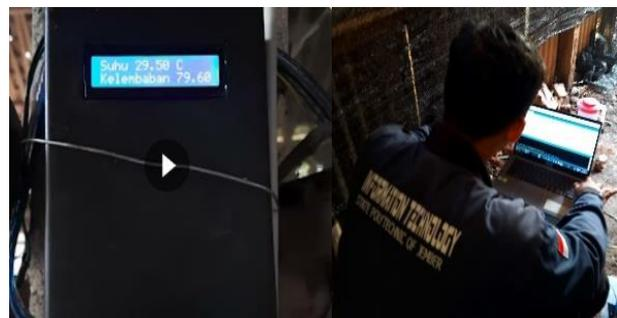
Gambar 6. Pengecekan pembacaan sensor suhu dan kelembaban
