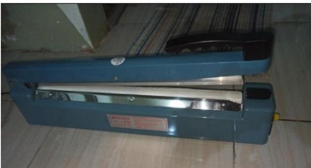
Mesin sealer yang digunakan adalah tipe hand sealer dengan panjang 40 cm. Mesin sealer ini menggunakan pemanas listrik yang diatur waktu penyalannya sesuai ketebalan plastik.
