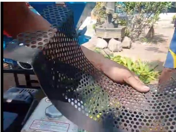
Gambar 4. Saringan untuk giling kotoran kambing
