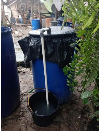
Gambar 3. Reaktor Pembuatan Pupuk Organik Cair
