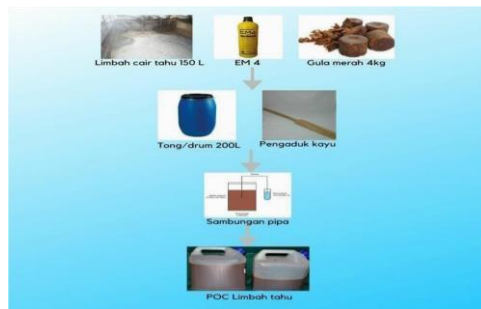
Gambar 1. Mekanisme Pembuatan Pupuk Cair Organik
