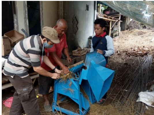
Gambar 4. Proses pemotongan limbah serai wangi menggunakan mesin chopper
